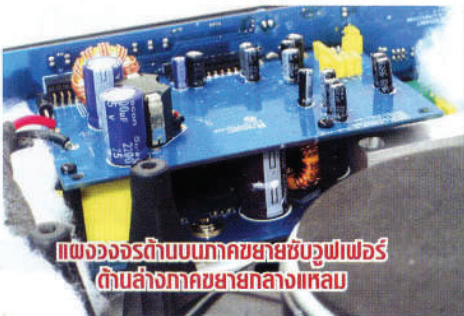
ไอซีภาคขยาย 4 แชนแนลติดอยู่กับอีกซีกกระป๋องความร้อน
